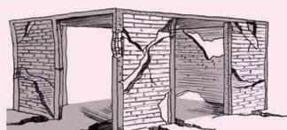
La maçonnerie de remplissage n'est pas compatible avec les cadres de béton armé sous sollicitation sismique. Il faut éviter ce type de construction (voir page 32).
