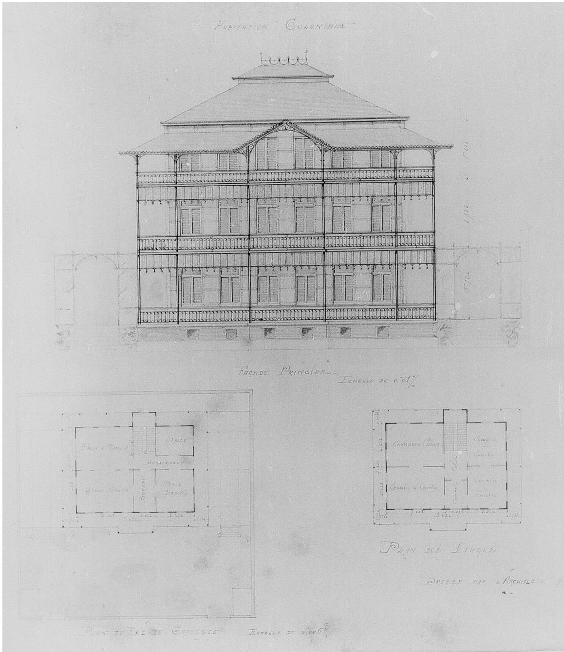
Elévation et plans d'un exemple de modèle de maison coloniale proposée à la vente par les Forges d'Aiseau en Belgique, 1885-1906. © KIK-IRPA, Brussels (Belgium), cliché M187585.
