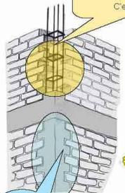
Le béton **S'INSÈRE** dans les indentations du mur de maçonnerie.
